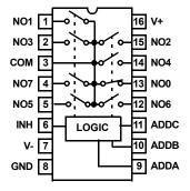
ISL84052 (16 LD SOIC, QSOP, TSSOP) TOP VIEW
