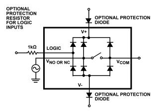
FIGURE 8. INPUT OVERVOLTAGE PROTECTION
