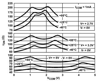
FIGURE 10. ON-RESISTANCE vs SWITCH VOLTAGE
