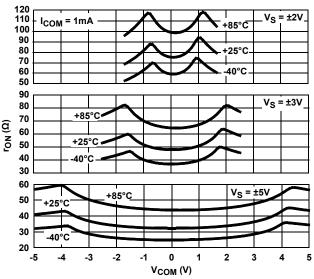
FIGURE 11. ON-RESISTANCE vs SWITCH VOLTAGE
