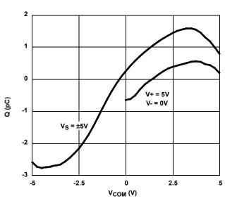
FIGURE 12. CHARGE INJECTION vs SWITCH VOLTAGE
