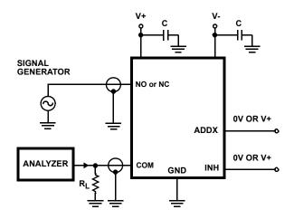
**FIGURE 4. OFF ISOLATION TEST CIRCUIT**
