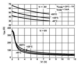
FIGURE 9. ON-RESISTANCE vs SUPPLY VOLTAGE
